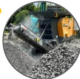
コンクリートガラと鉄材を選別した後でさらに細かく破碎、減量化する作業に使用します。最小 15 mmのサイズで破碎ができ、クローラー式なので現場内での移動も容易にできます。
