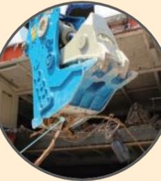
鉄くずを永久磁石で吸着してコンクリートガラと鉄材の選別に使用します。1 台で2役を担い現場の人員不足やコスト削減などの問題を軽減します。
