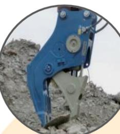
大割機で破碎したコンクリート塊を二次破碎して、鉄筋とコンクリートを分離・分別する作業に使用します。
