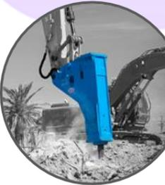
コンクリートの基礎やアスファルトなどの地面、一次圧砕した後のコンクリートをより細かくする作業に使用します。
