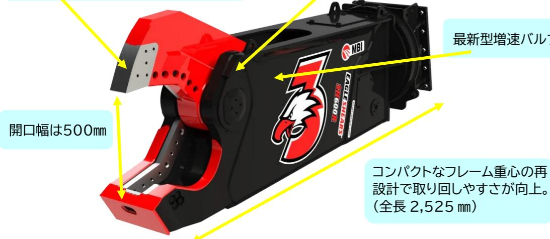
【突刺】【裂断】【剪断】の3種類の組み合わせでの切断工法で、作
