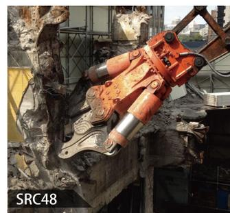
シリーズ特長を引き継いだ大型鉄骨鉄筋コンクリート解体機
